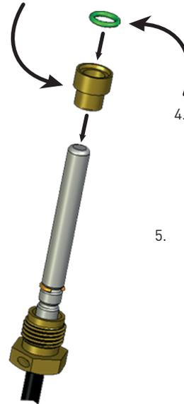
4. O-Ring (grün) bis in die Nut der Direktmessungshülse schieben.
