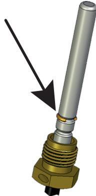
3. Direktmessungshülse auf den Temperaturfühler stecken und diesen bis auf die Temperaturfühlermutter schieben.
